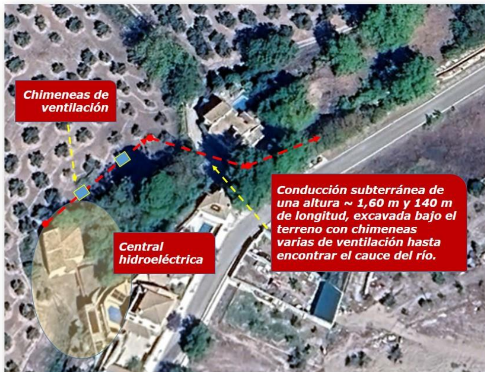
43_ Trazo de la conducción subterránea desagüe central.
