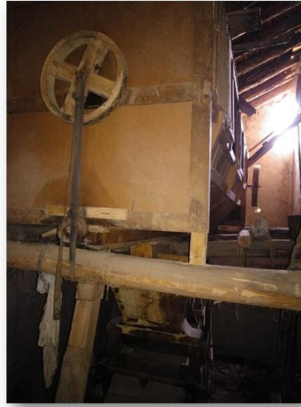
Máquina auxiliar nº 2: <Separador> de diferentes clases de cereales desmenuzados por la molienda: Harina blanca fina para la fabricación del pan, moyuelo y salvado (según el tamaño de la molienda).
