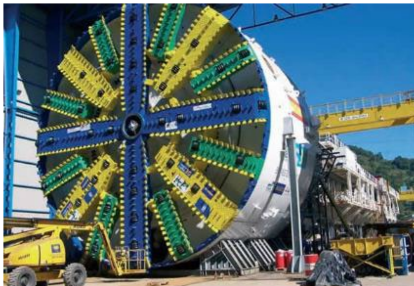
Figura 10: Escudos (en primer término) y back-ups de las tuneladoras “Dulcinea” (arriba) y “Tizona”, empleadas en la construcción del by pass sur de la M-30 [23].
