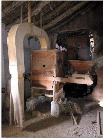
Máquina auxiliar nº 1: <Semillador> Limpia previamente de tierra, elementos extraños, semillas... el cereal que llega al molino antes de proceder a la molienda (Ubicada en el terrado).
