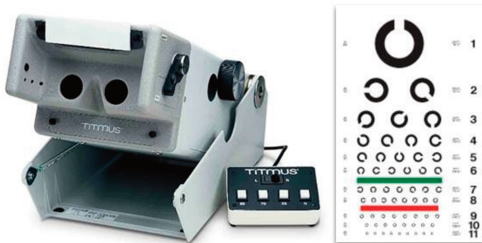
Imagen 1: equipo utilizado para el examen de la agudeza visual y optotipos de Landolt
