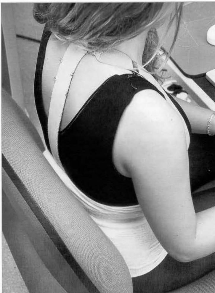
Figura 1. Raquímetro extensométrico
