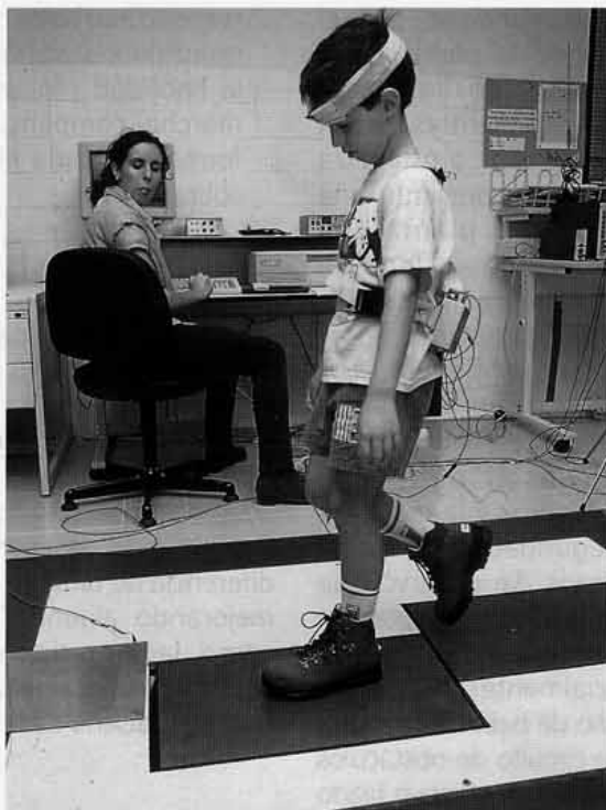
Análisis de fuerzas de impacto y aceleraciones en la tibia y en la cabeza.
