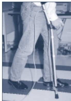
Figura 3: Dinascan IBV y muleta instrumentada
