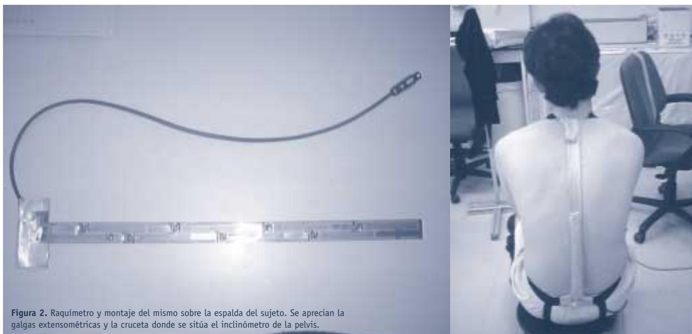
Figura 2. Raquímetro y montaje del mismo sobre la espalda del sujeto. Se aprecian la galgas extensométricas y la cruceta donde se sitúa el inclinómetro de la pelvis.
