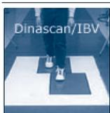
**Dinascan/IBV.** Plataforma dinamométrica diseñada para el registro y análisis de las fuerzas y momentos realizados por el sujeto en estudio sobre el suelo (terrazos, parquets, cauchos, hierba, etc) durante cualquier tipo de actividad humana (deambulación, saltos, giros, bipedestación, carrera, etc).
