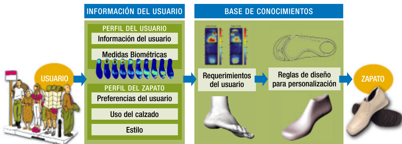
Figura 4. Esquema de desarrollo de calzado personalizado puesto a punto en el proyecto europeo EuroShoe.
