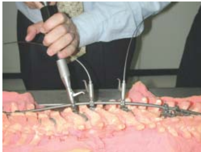
Figura 2. Ensayo sobre modelo sintético para evaluar el instrumental con el que se realiza la tracción.
