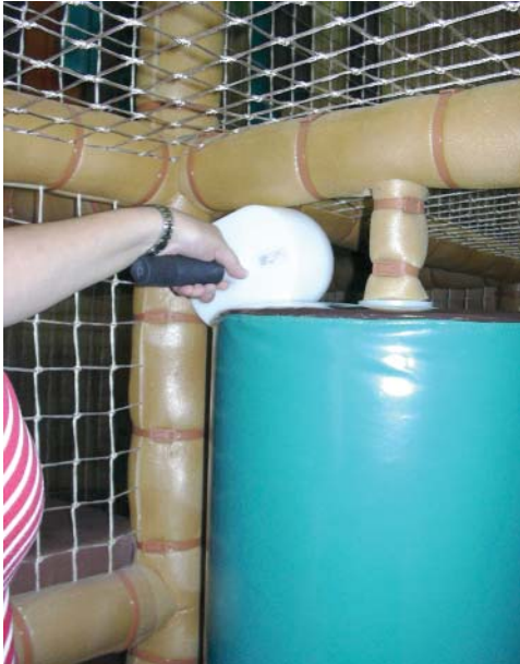
Figura 1. Análisis de atrapamientos en equipamiento deportivo de acuerdo a normativa EN-1176-1.
