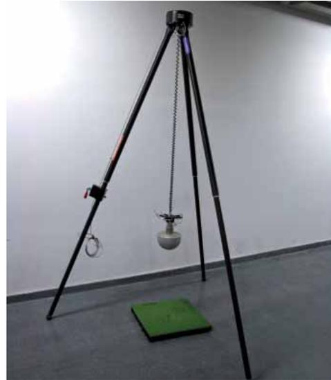
Figura 2. Dispositivo de ensayo de la capacidad de amortiguación (HIC).
