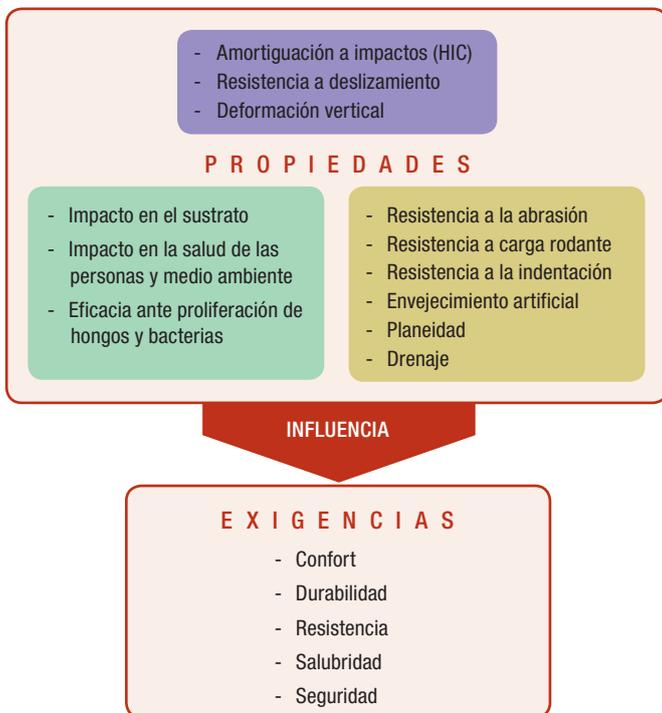
Figura 1. Esquema de organización de las propiedades relevantes y la influencia sobre las exigencias de un pavimento continuo de caucho.
