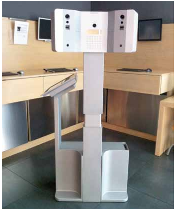
Figura 1. Sistema para capturar en la óptica la morfometría 3D del usuario.
