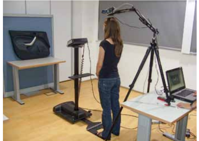
Figura 4. Montaje de ensayo para seguimiento de la mirada sobre el producto real (EyeTracker Tobii X120).
