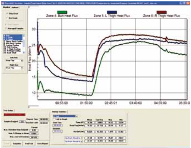
Figura 3. Pantalla de control del software ThermoDAC que permite modificar las condiciones del ensayo.
