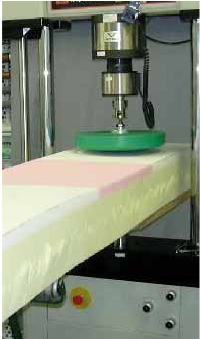
Figura 6. Instrumento utilizado para la medición de la firmeza según el procedimiento del IBV.
