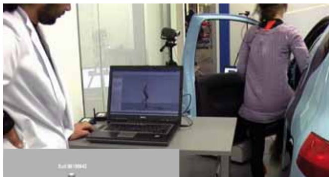
Figura 4: Análisis del movimiento y simulación virtual de la entrada y conducción de un vehículo mediante sensores inerciales (IBV).
