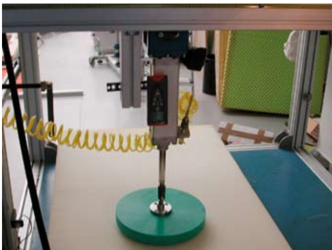
Figura 6. Instrumento utilizado para la medición de la firmeza según el procedimiento del IBV.
