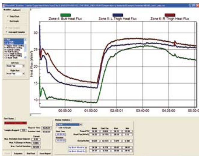
Figura 5. Pantalla de control del software ThermoDAC que permite modificar las condiciones del ensayo.
