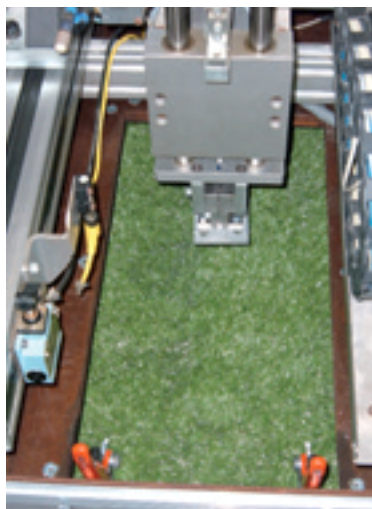
Figura 4. Máquina de ensayo de fricción (arrancado de chuleta).
