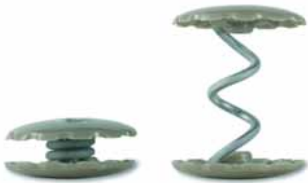
Figura 1. BHID antes y después de su deformación en frío.
