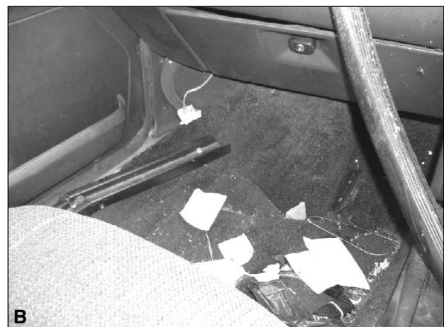
**Figura 1. A.** Estado del vehículo luego del accidente. **B.** Deformidad del piso de la cabina del lado del acompañante.
